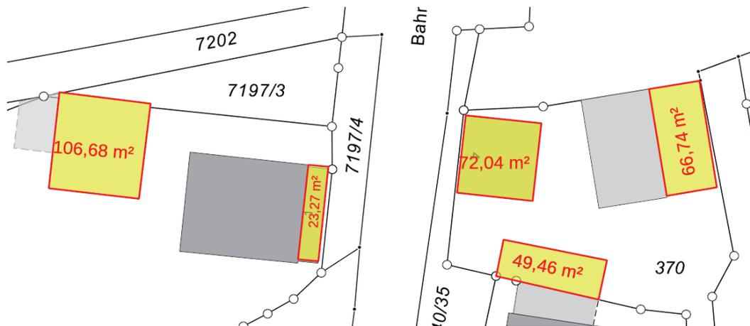
Das Vorderhaus Bahnhofstraße 1 wird zurückgebaut, saniert und erhält rückwärtig einen Anbau mit einem extensiven Gründach. Die Anbaufläche beträgt 367,21 m<sup>2</sup> (dunkelrot eingefärbte Flächen). Die hellrot eingefärbten Flächen sind befestigte Vorzonen des Gebäudes und entwässern unmittelbar in die angrenzenden Grünflächen.
